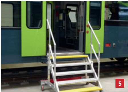
5. Mobile Einstiegshilfen mit Gummi – Anfahrerschutz, 10 Stück als sicherer Zustieg in die Züge, an jeder beliebigen Position in der Werkstatt einsetzbar
