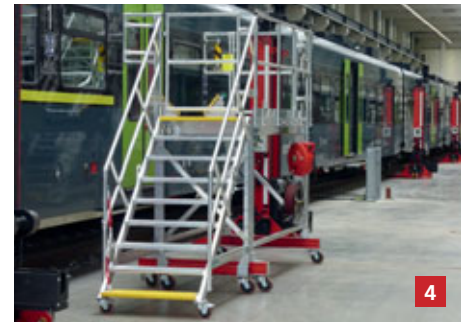
4. Mobile Seitenarbeitsbühne zum Bearbeiten der unteren Seitenbereiche
