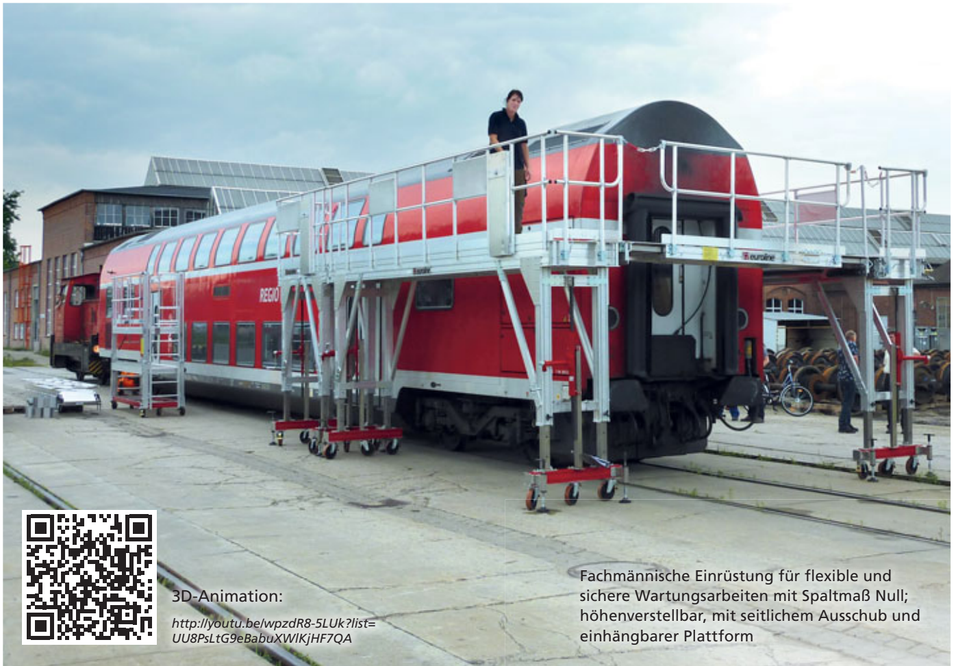
Mobile Dacharbeitsbühne mit Höhenverstellung – für komfortable und schnelle Instandsetzungen
