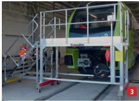
3. Mobile Frontarbeitsbühne für geschütztes Arbeiten im Front- und Stirnbereich
