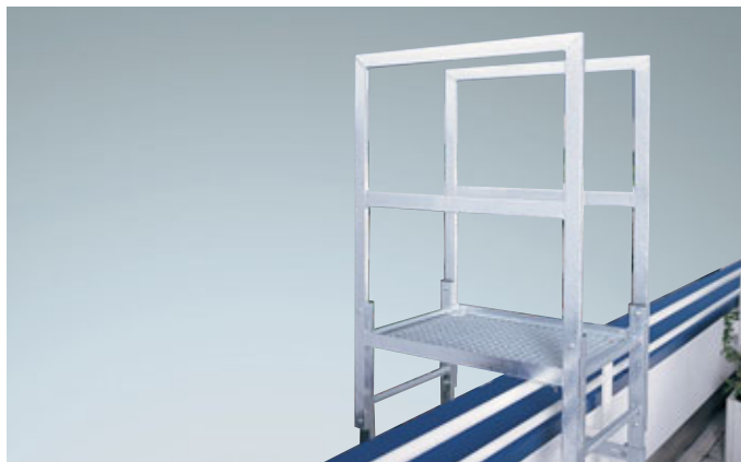
Attika-Überstieg Mit Gitterrost, Stahl verzinkt, Abstiegsleiter 1220 mm lang, Ablängung bauseitig. Für den Abschluss am Abstieg empfehlen wir verstellbare Wandanker oder Fußplatten.
