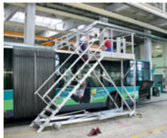
Schnell und garantiert sicher: Wartungsbühne mit Zentralfeststellung
