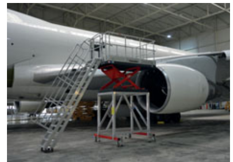
Hydraulisch höhenverstellbare Wartungsbühne
