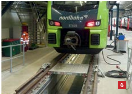
6. Gleisplatten, 2 Stück zum sicheren Überqueren der Gleisgruben
