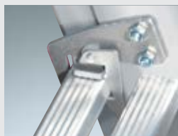
Spezial-Steckhaken (verschraubt) mit großer Auflagefläche auf der Sprosse und zuverlässigen Sicherungshaken; alle Mehrzweckleitern und Schiebeleitern sind von Sprosse zu Sprosse ausziehbar
