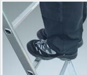
Sprossen mit 32 mm waagerechter Auftrittsfläche für sicheren und ermüdungsfreien Stand, Sprossenabstand 280 mm
