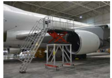
Hydraulisch höhenverstellbare Wartungsbühne
