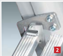
(2) Spezial-Steckhaken (verschraubt) mit großer Auflagefläche auf der Sprosse und zuverlässigen Sicherungshaken
