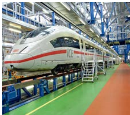
Fahrbare Wartungsbühnen, vielseitig einsetz- und erweiterbar durch unser modulares Baukastensystem
