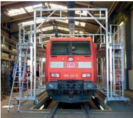
Mobile Dacharbeitsbühne mit Höhenverstellung – für komfortable und schnelle Instandsetzungen
