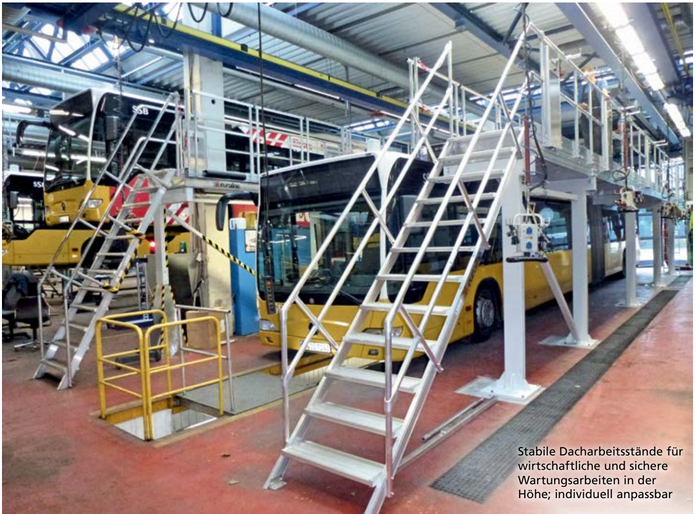
Schnell und garantiert sicher: Wartungsbühne mit Zentralfeststellung
