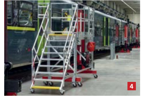
4. Mobile Seitenarbeitsbühne zum Bearbeiten der unteren Seitenbereiche
